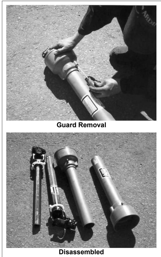
Fig. 46 DRIVELINE COMPONENTS
