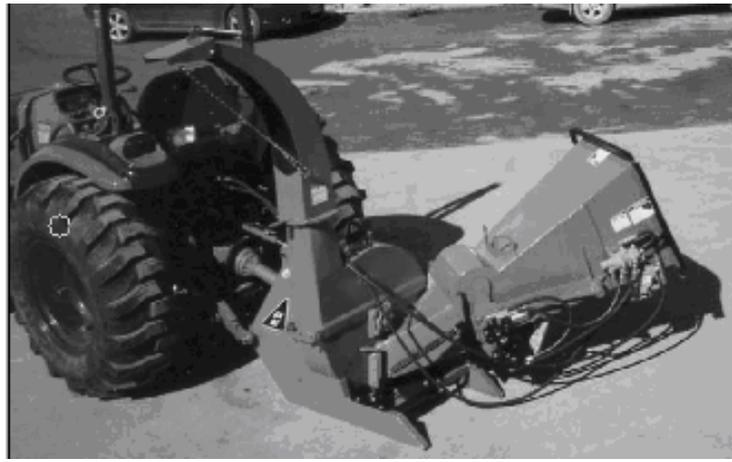
**Fig. 23 FEED HOPPER/DISCHARGE HOOD**
