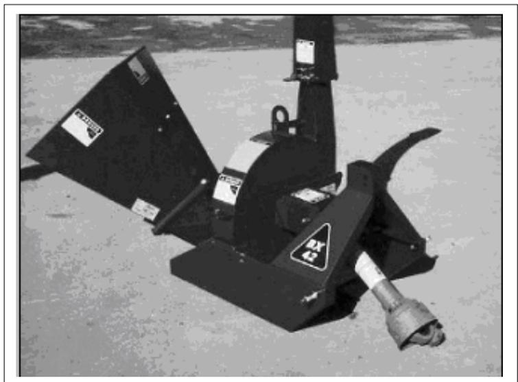
**Fig. 9 DISCHARGE CHUTE**
